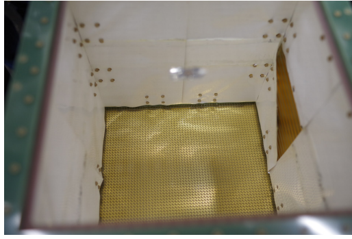
図 5.11: TPC 内壁と TPB 蒸着後の ESR (接着剤使用)
