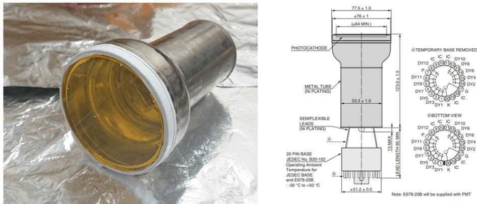
図 4.3: 今回使用した PMT(R11065) の写真(左)と寸法(右)[33]
