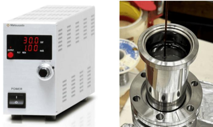
図 4.6: Cathode に使用した電圧源 (左) とエポキシ樹脂でケーブルを固定したフィードスルー (右)
