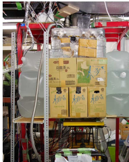
図 5.2 鉛・水シールドを積んだ状態
