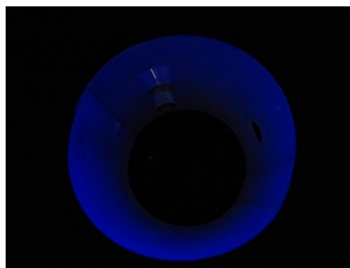
図 3.4.8 TPB を蒸着した ESR にブラックライトを当てた様子
