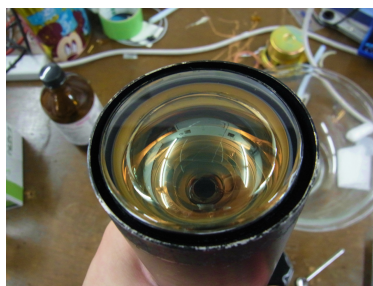
図 3.3.2 高分子マトリックス法 により TPB を塗布された PMT
