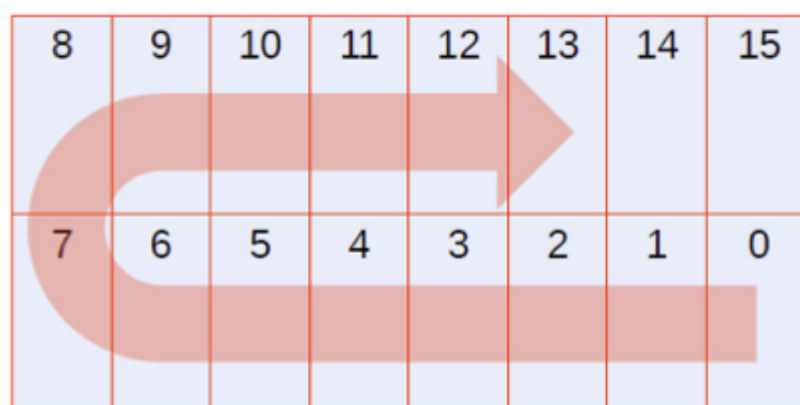
図 5.4: Pixel module の FE の読み出し順序
