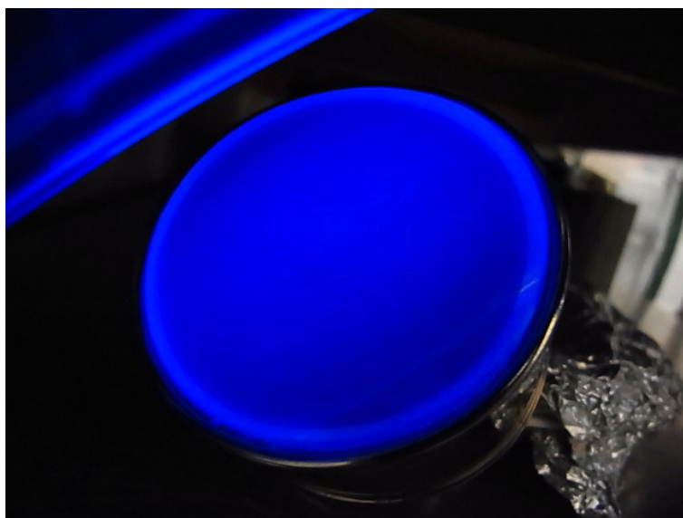
図 2.11: TPB が真空蒸着された反射材
