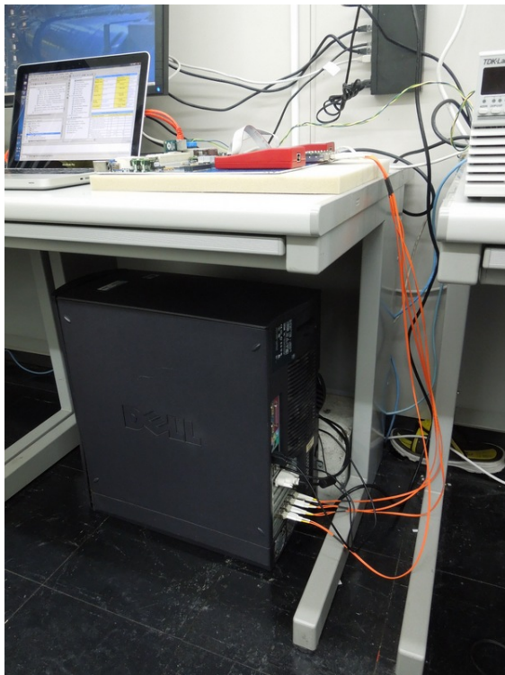
図 5.12 早稲田大学における QUEST - Input Mezzanine - Data Formatter のセットアップ
